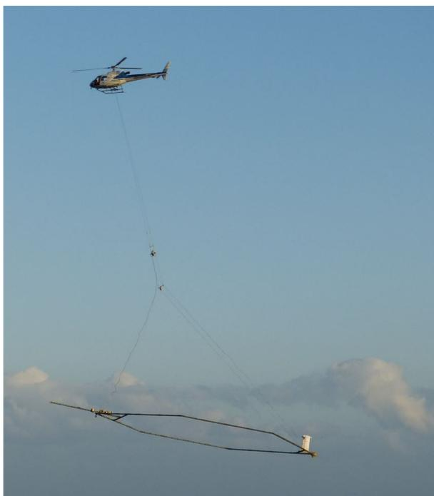
Figure : Dispositif géophysique hélicoptéré
